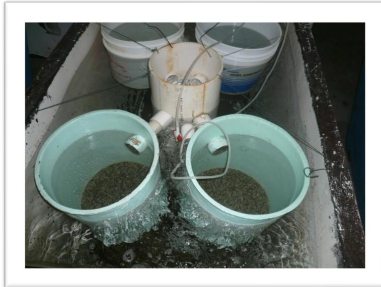
**Figura 65 - Tanque de assentamento de larvas de ostras em laboratório.**
