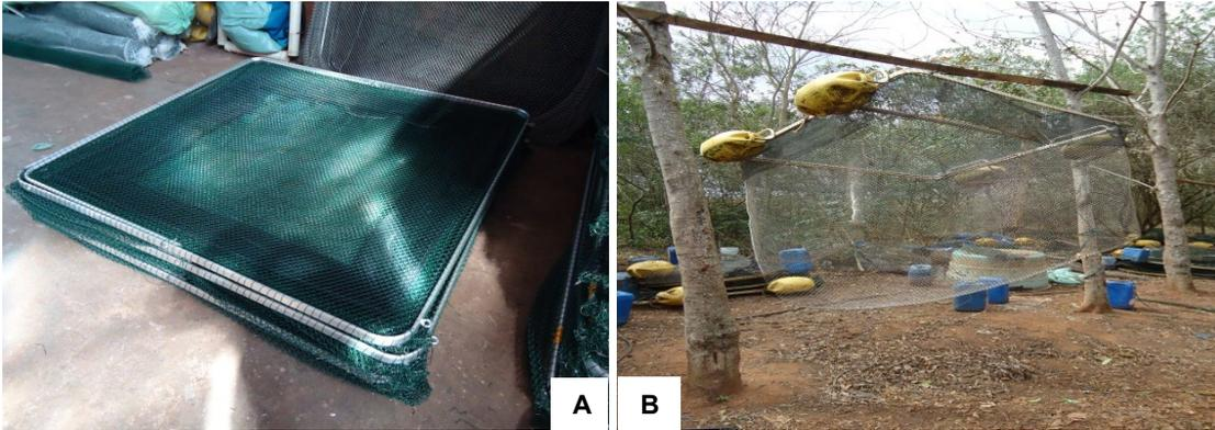
Figura 11. Modelos de tanques-rede mais utilizados na região. A: Tanque-rede de 6m<sup>3</sup>, estrutura em alumínio e tela de aço galvanizado revestido com PVC. B: Tanque-rede de 6m<sup>3</sup>, estrutura em alumínio e tela de aço inox
