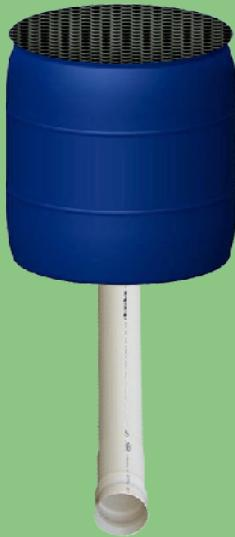
Depois, com um GALÃO de 50 litros, você coloca uma TELA de um lado e um CANO de saída no outro. Isso vai servir para armazenar e direcionar a água sem galhos e folhas para seu açude.
