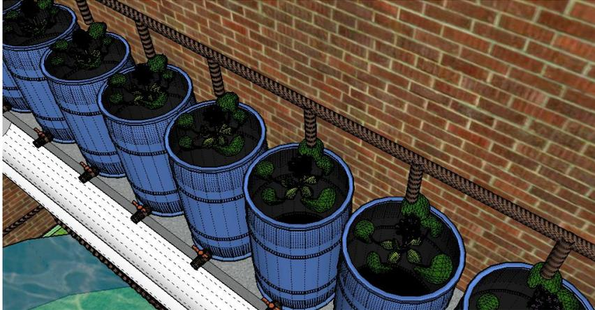
O sistema contará com 20 biofiltros: 11 para o tanque de 36,37 m<sup>3</sup> e 9 para o tanque de 25,89 m<sup>3</sup>. O biofiltro consiste em um tambor que é dividido em 3 camadas: aguapé (planta filtradora) - camada superior, manta acrílica envolvida em tela plástica e a última camada é composta por zeólito - mineral poroso com alta capacidade absorção.
