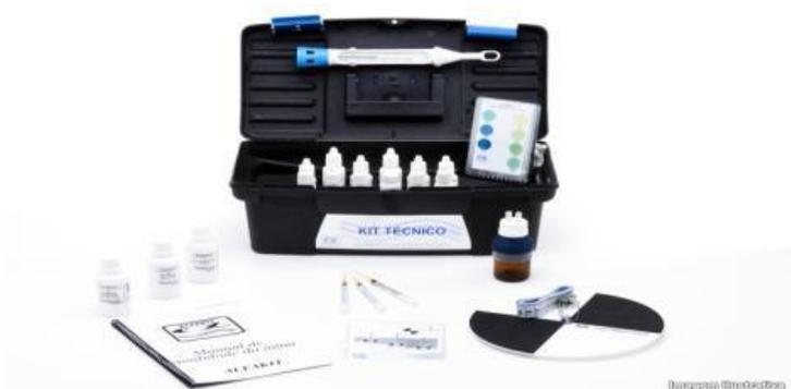
Será adquirido um kit de análise de água, a fim de monitorar: oxigênio dissolvido, pH, amônia total e amônia tóxica, transparência (será avaliada através do Disco de Secchi), dureza em carbonatos KH e nitrito. As análises serão realizadas, inicialmente, a cada 2 dias e, quando a qualidade da água se manter “estável” em boas condições, as análises serão realizadas em intervalos maiores de tempo: a cada 5 ou 7 dias.
