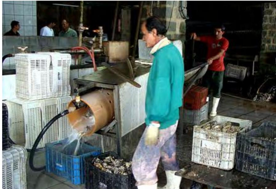
**Figura 54.** Retirada do incrustantes das ostras mecanicamente.
