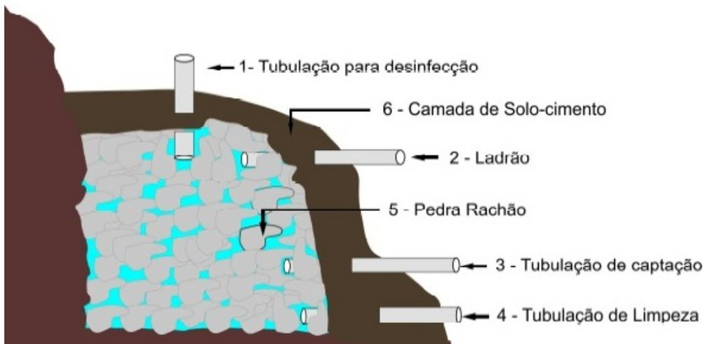
Figura 12 - Imagem esquemática de recuperação das nascentes
