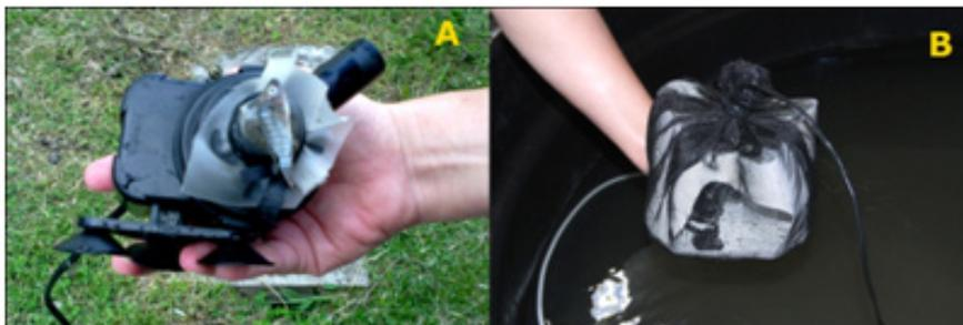
Figura 5 (A) Foto representando como os alevinos eram sugados pela bomba, impedindo a circulação de água e ocasionado a morte dos mesmos; (B) Bomba envolta com a tela, para proteger os peixes evitando que fossem sugados.
