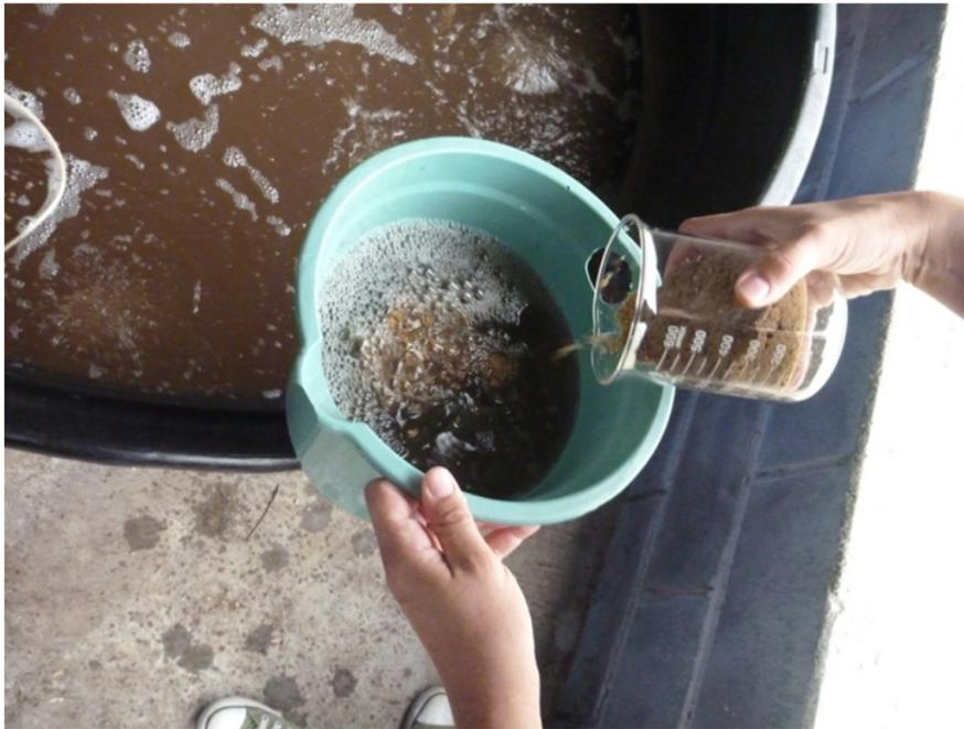
Figura 19 Adição de fonte de carbono (açúcar mascavo) aplicado no 25º dia do desenvolvimento do protótipo.
