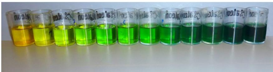
Figura 14 - Tubos contendo todas as diluições de amônia submetidas a teste, que posteriormente foram colocadas no espectrofotômetro.
