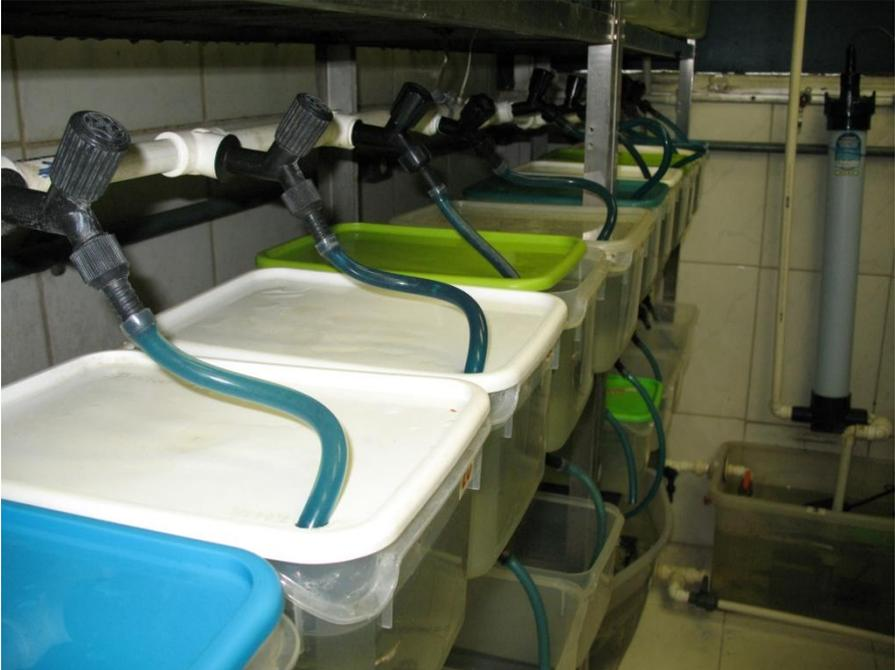
**Figura 21** Tanques inseridos em um sistema de recirculação, com torneiras de plástico sendo utilizadas como reguladores de fluxo - UFRJ.
