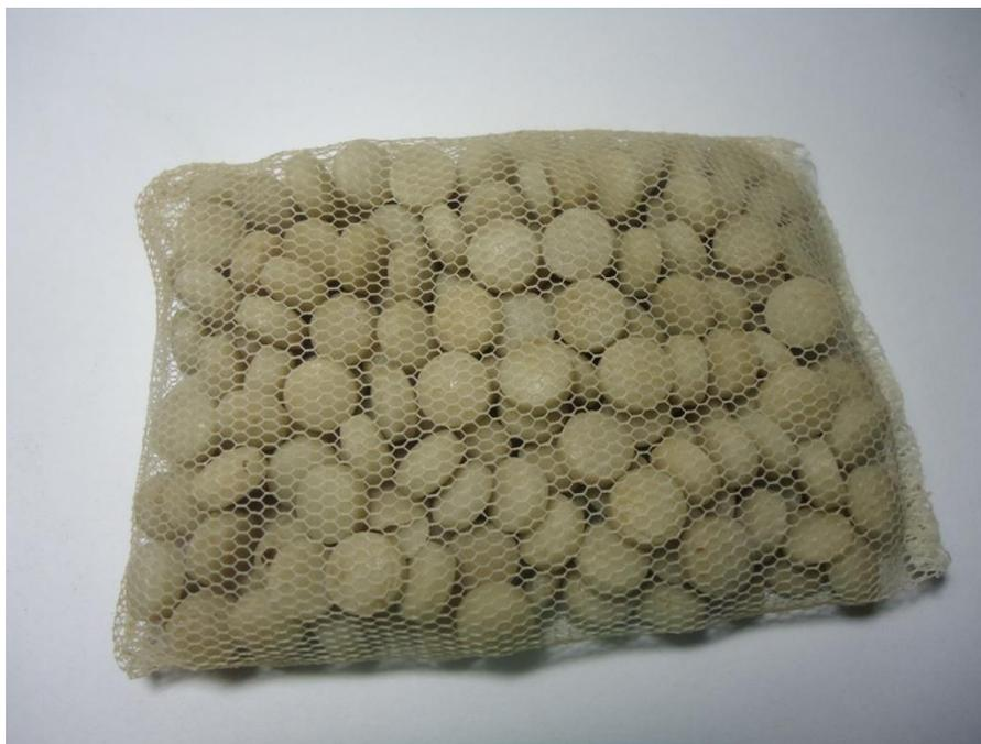
**Figura 23** Os microporos do vidro sinterizado permitem a fixação de uma grande quantidade de bactérias responsáveis pela filtração biológica.
