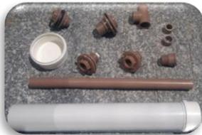
Tubos e conexões. São necessárias dois flanges de 1 polegada; 1 flange de 25 mm de diâmetro; 4 canos com: 25, 50, 75 e 100 mm de diâmetro;
