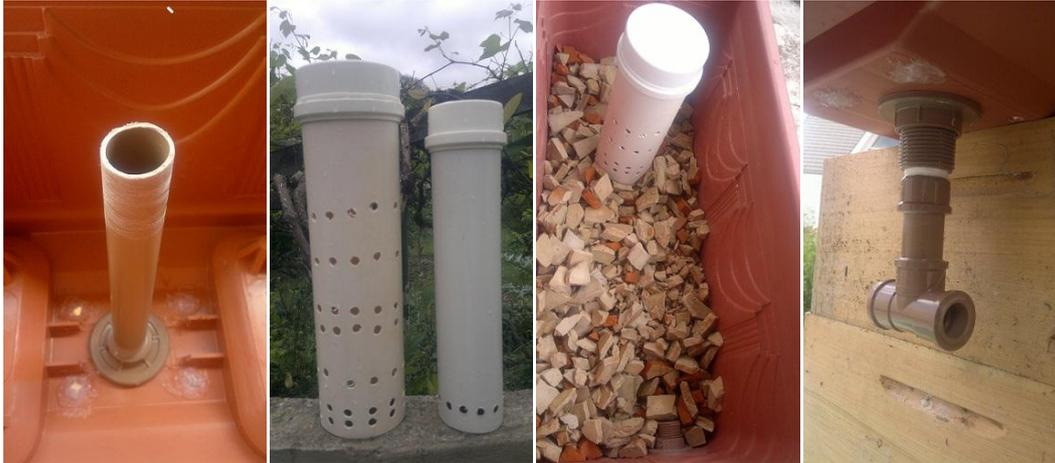
**Figura 6** Estruturas formadoras do sifão.
